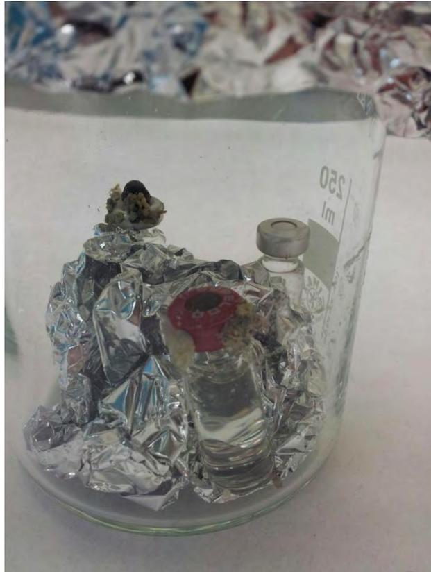
**Abbildung 4.2-1 Austestung verschiedener Kappen für die Hydrolyse.** Dieses Bild zeigt die Vials nach einer 24 h langen Hydrolyse im Trockenschrank. Zur Sicherheit wurden sie in einem Becherglas verwahrt. Deutlich ist zu erkennen, dass zwei von drei Kappen bzw. Septen mit der Salzsäure reagiert haben. Nur die Kappe des Vials hinten rechts ist gänzlich unversehrt. Sie besteht aus Red Teflon® mit einem Silikonseptum.
