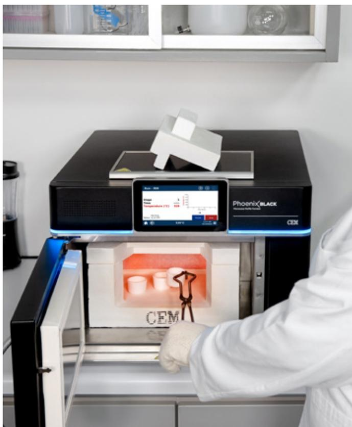
Abbildung 3: Phönix Black SAS Tiegel einsetzen
