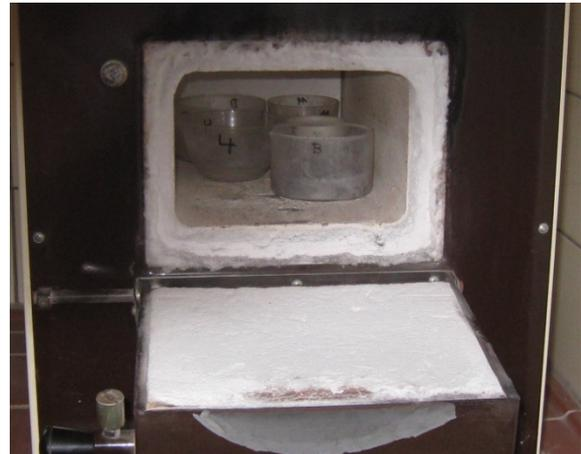
Abb. 4.3: Geöffneter Muffelofen
