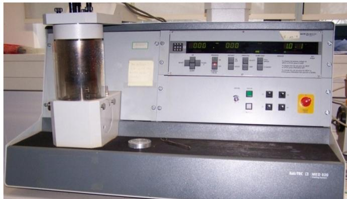
Abb. 4.7: Hochvakuum Kleinbeschichtungsanlage [eigenes Foto]
