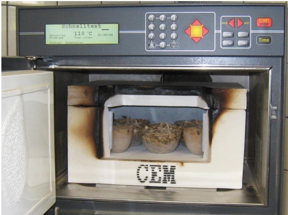
Abb. 4.4: Geöffneter, mit Tiegeln bestückter Mikrowellen-Muffelofen
