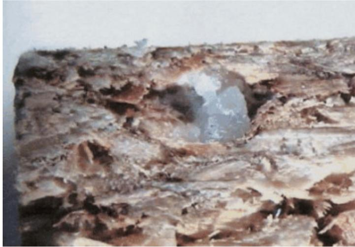
Abb. 3.26: Im Plattenwerkstoff verbliebener Teil eines Sandkorns
