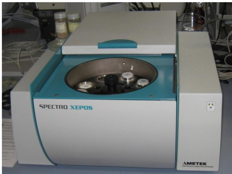
Abb. 4.9: Röntgenfluoreszenzspektrometer [eigenes Foto]
