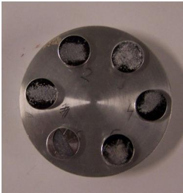
Abb. 4.6: Probenhalter mit Proben [eigenes Foto]
