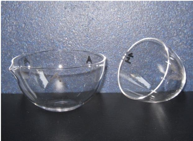
Abb. 4.2: Quarzglastiegel
