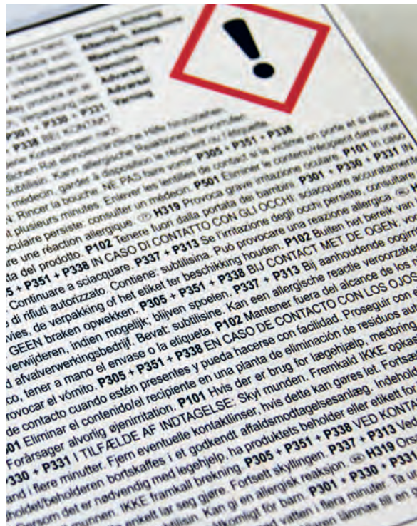
Abb. 9.2.1: Mehrsprachige Gefahrenkennzeichnung auf einer gefährlichen Zubereitung
