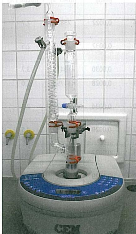
Abb. 2: ...und ausgestattet mit Rückflusskühler und Tropftrichter
