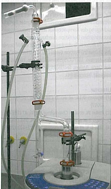
Abb. 1: CEM Labormikrowellengerät ausgestattet mit Rückflusskühler und Wasserabscheider
